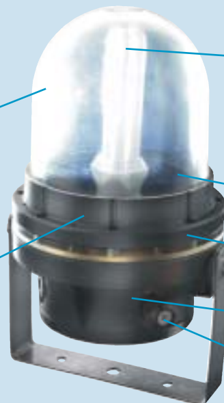
Kunststoffgehäuse aus glasfaserverstärktem Polyester – Korrosionsschutz, Schutzklasse II (kein Potentialausgleichsleiter erforderlich) Synthetic housing made of glassfibre reinforced polyester (GRP) – corrosion free, insulation class II (no equipotential bonding necessary)
